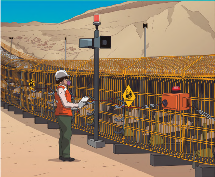
Sistema de parada de emergencia (C.C.)
